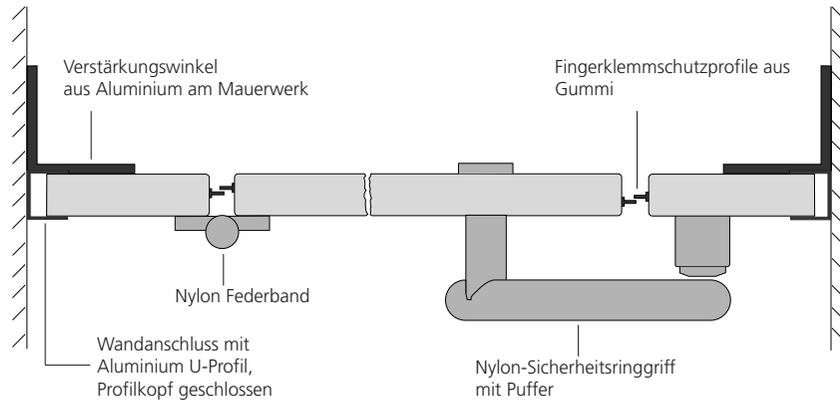
Stabilisierungslösung bei breiten Fronten
